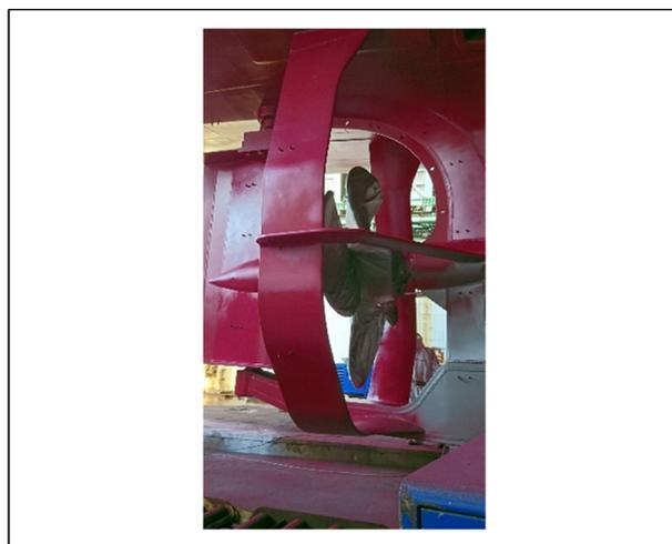
図3. 漁船に搭載された新型プロペラガード
