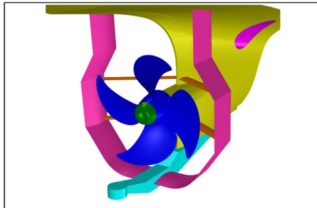
図2. 考案した新型プロペラガードの模式図
