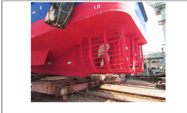
図1. 漁船に装備されたプロペラガードの例
